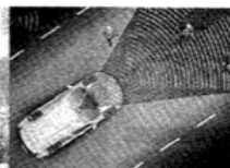
A sinistra, la Volvo V60. Nelle illustrazioni: a sinistra, come funziona il Pedestrian Detection (sfrutta una telecamera per riconoscere i pedoni ed è in funzione sino a 80 km/h); a destra, il dispositivo che permette all'auto di mantenere sempre elettronicamente la distanza di sicurezza
